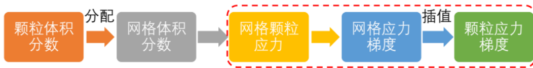
图 5 颗粒应力梯度计算步骤
